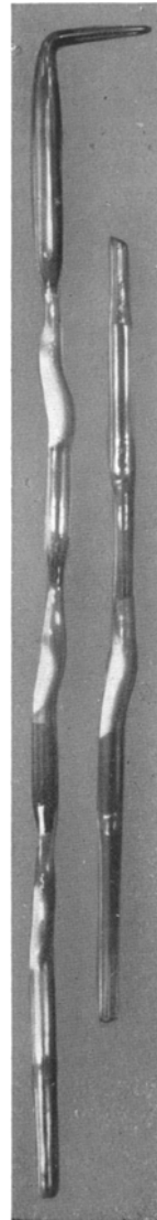
Abb. 5. Arsen Spiegel aus Aschen von Leichen, die nicht mit Arsen behandelt worden sind.
